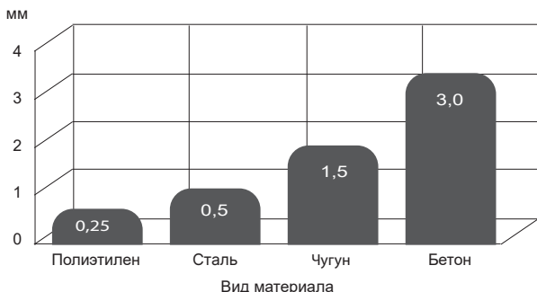
Рисунок 2. Шероховатость внутренней поверхности труб из различных материалов.
