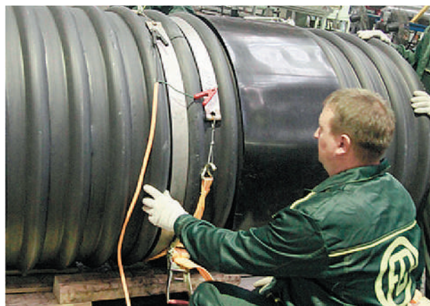
Рисунок 15. Схема соединения труб с помощью уплотнительного кольца
